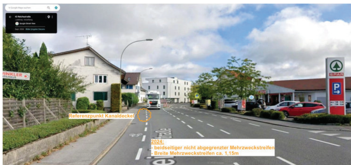
ABB. 21 — Dieselbe Blickachse 2024: nicht abgegrenzter Mehrzweckstreifen mit rund 1,15 m — derselbe Kanaldeckel als Bezugspunkt. Quelle: Google Streetview 2024.
