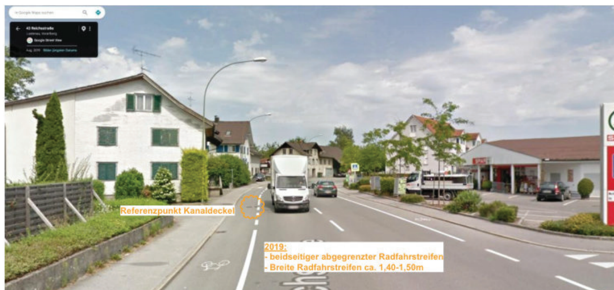
ABB. 20 — Straßenansicht 2019: beidseitig abgegrenzte Radfahrstreifen mit rund 1,40 bis 1,50 m Breite. Bezugspunkt beider Aufnahmen ist der markierte Kanaldeckel im Vordergrund. Quelle: Google Streetview 2019.
