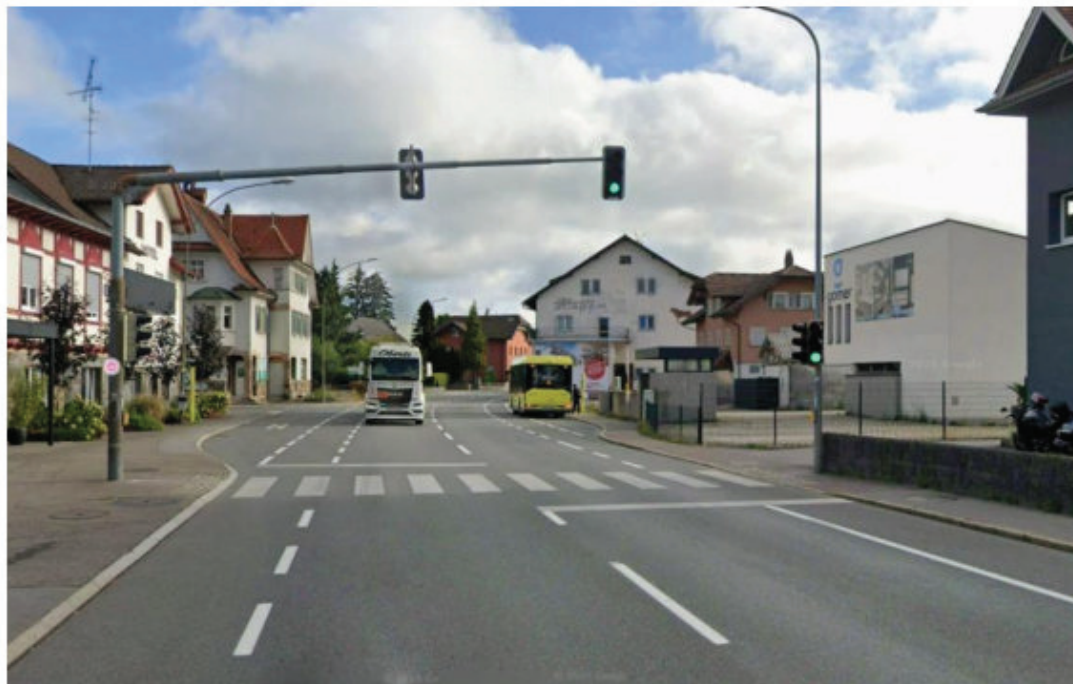
ABB. 18 — Derselbe Bereich 2024: die Mittelinsel fehlt, die Querung erfolgt in einem Zug über die gesamte Fahrbahn. Quelle: Google Streetview 2024.
